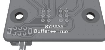
Skjut brytaren åt höger för True Bypass
