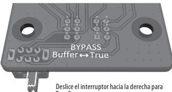
Deslice el interruptor hacia la derecha para True Bypass
