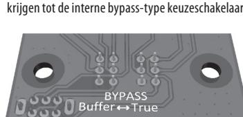
Skjut brytaren åt höger för True Bypass
