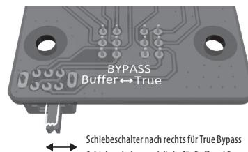
Schiebeschalter nach rechts für True Bypass
